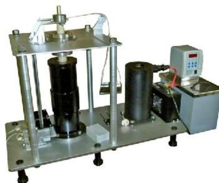
Мехатронное измерительное устройство для определения зависимости теплофизических характеристик жидких полимерных материалов от скорости сдвига
