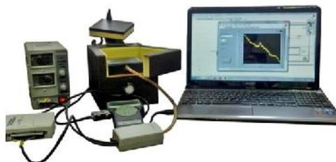
Измерительное устройство для определения зависимости теплофизических характеристик дисперсных материалов
