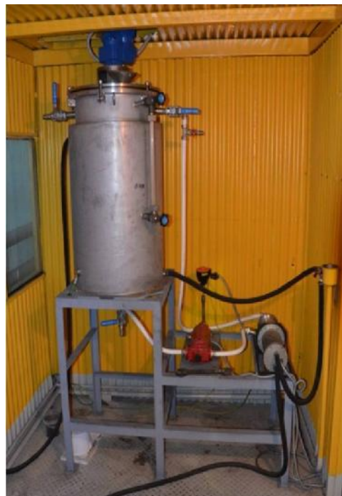
Пилотная установка получения добавки. Производительность 450 ÷ 500 л/смену (на 5000 т бензина).
