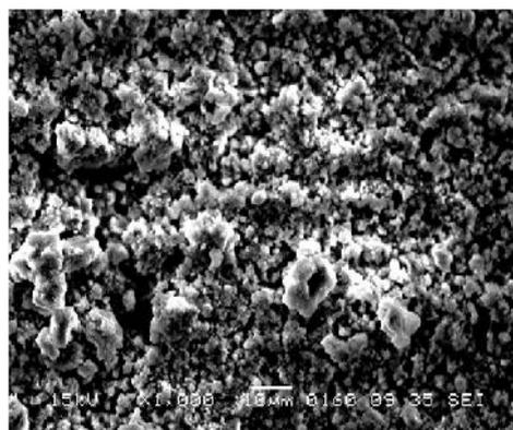
Структура наномодифицированного бетона
