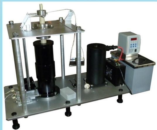
Автоматизированная измерительная установка для определения зависимости теплофизических характеристик жидких полимерных материалов от скорости сдвига и температуры
