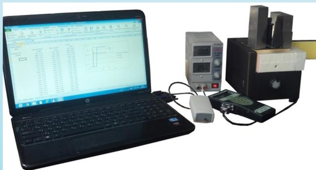
Установка для определения теплофизических свойств дисперсных материалов с учетом их пористости
