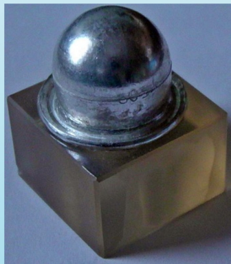
Al-катод 285-3, приваренный к ситаллу СО-115М
