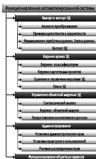
Рис. 8. Декомпозиция процессов функциональной модели ЭА
