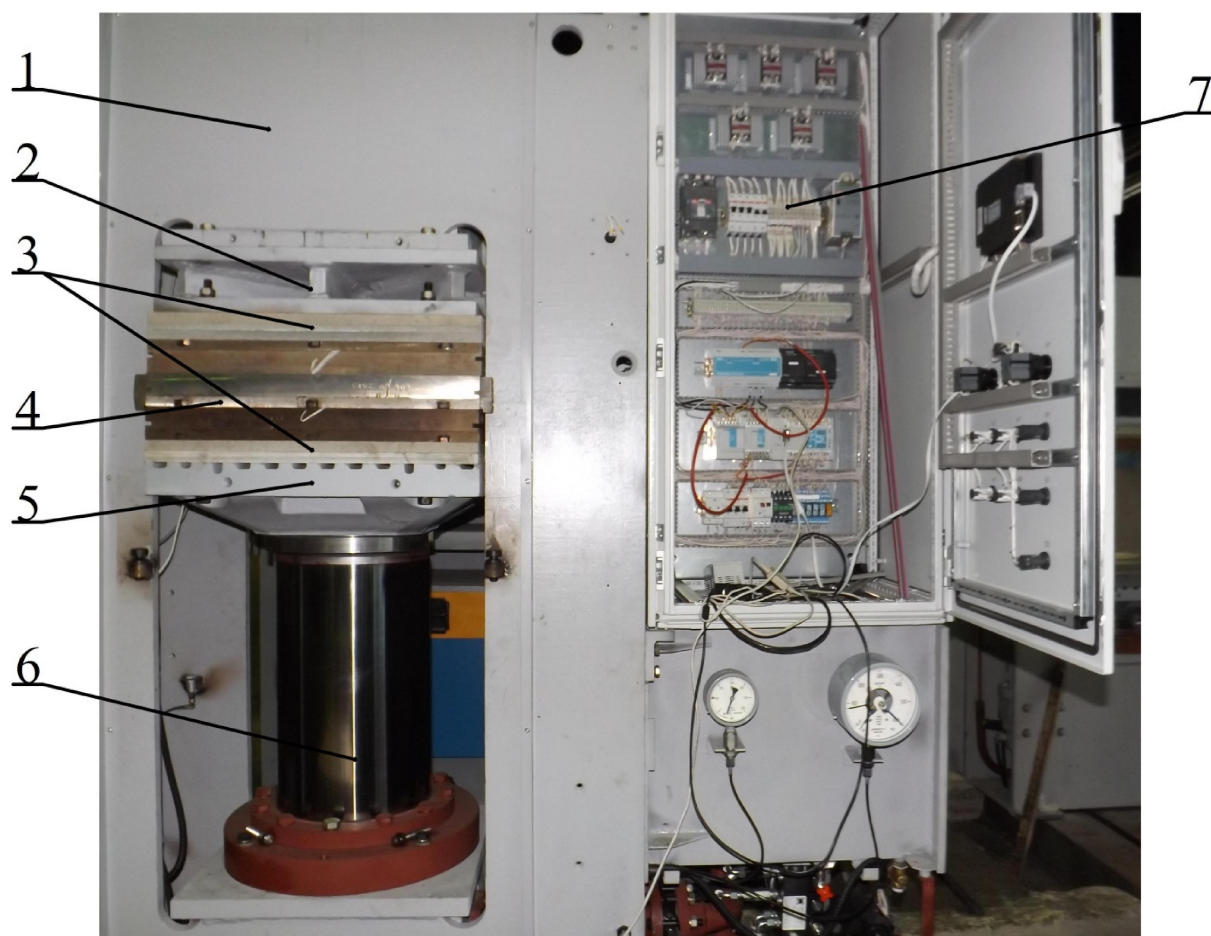
Рис. 1.1 – Пресс гидравлический вулканизационный 250-600 2Э 1 – корпус пресса; 2 – верхняя поперечина; 3 – теплоизоляционные плиты; 4 – нагревательные плиты; 5 – подвижный стол; 6 – плунжер; 7 – шкаф управления
