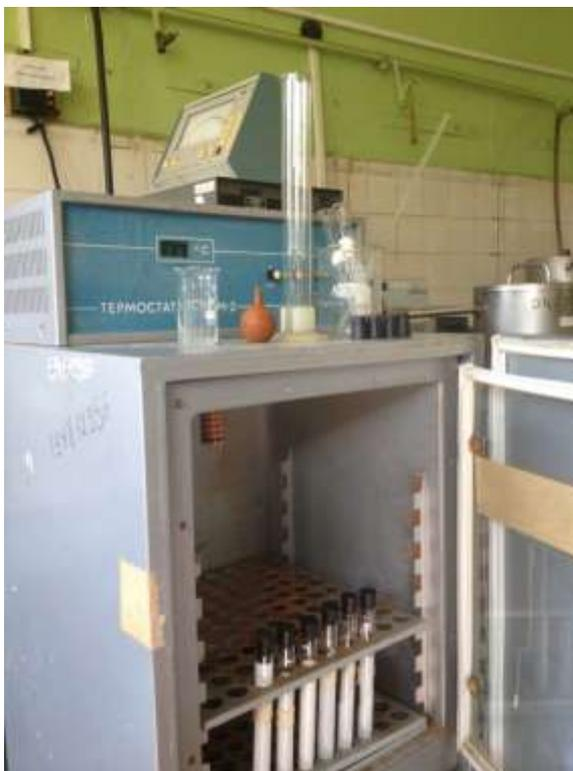
Рис. 2.5. Термостат ТС-80М2
