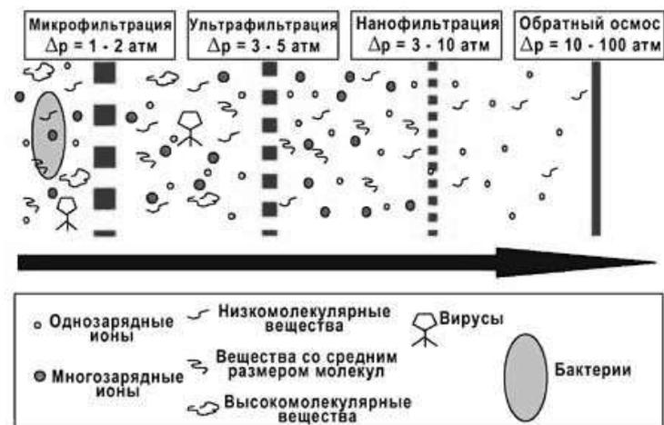
Рис. 1.2. Классификация баромембранных процессов по удаляемым примесям [ 12]
