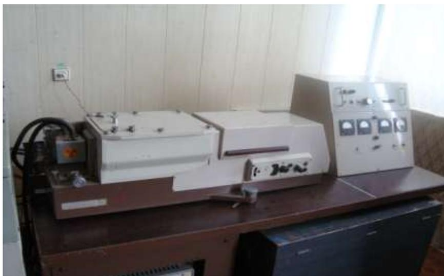
Рисунок 2.1. Малоугловая установка рентгеновского рассеивания
