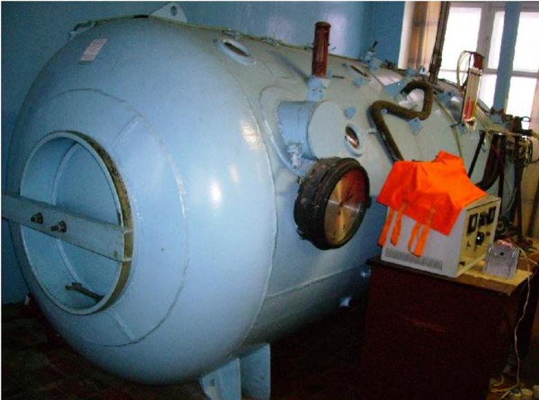
Рисунок 2.2 - Внешний вид испытательного стенда с объемом испытательной камеры 6,3 м<sup>3</sup>
