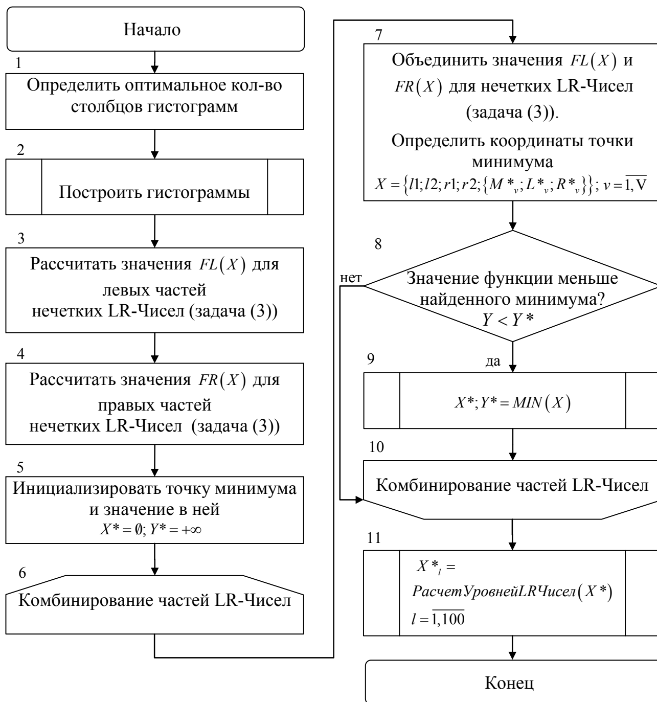
Рисунок 3.4 – Процедурная модель определения коэффициентов LR-чисел, соответствующих параметрам СИС
