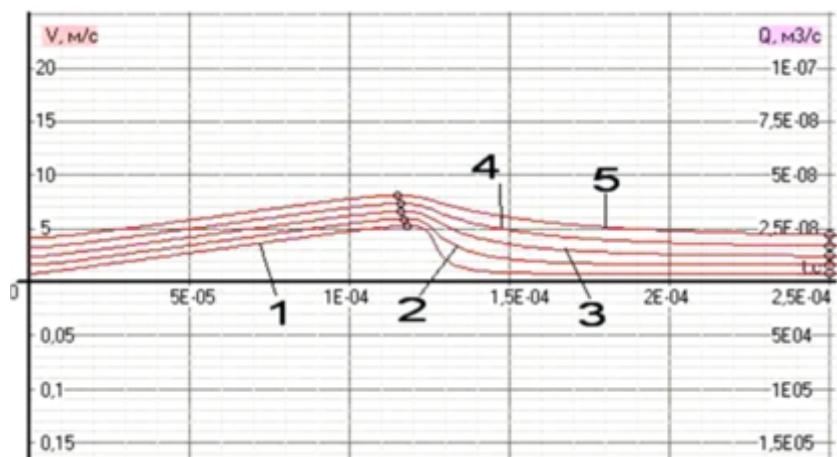
Рис. 7.1. Графики зависимостей скорости потока жидкости в канале статора от времени, при различных величинах зазора между ротором и статором. 1- \delta = 5 \cdot 10^{-5} м; 2- \delta = 1 \cdot 10^{-4} м; 3- \delta = 1,5 \cdot 10^{-4} м; 4- \delta = 2 \cdot 10^{-4} м; 5- \delta = 2,5 \cdot 10^{-4} м.
