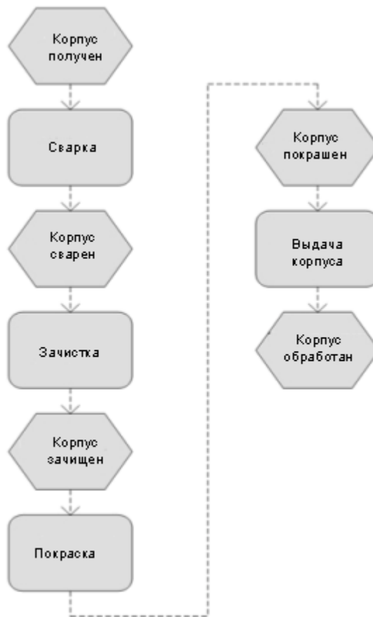
Рис. 76. Модель ARIS eEPC, описывающая процесс обработки корпуса.
