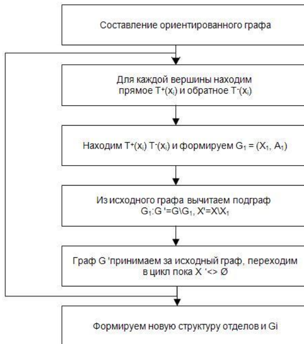
Рис.17. Алгоритм сведения числа функциональных подразделений до N в составе отделов путем разделения.
